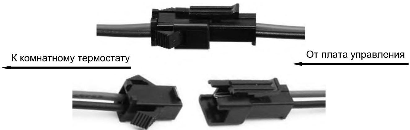
Рис. 43 Двухконтактный коннекторный разъём «папа-мама».
